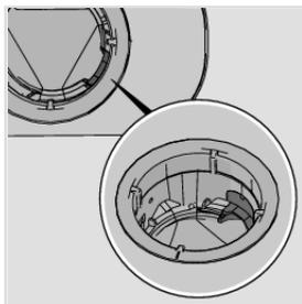
Verificare che il fermo colorato situato a destra del drenaggio inferiore sia al suo posto.
